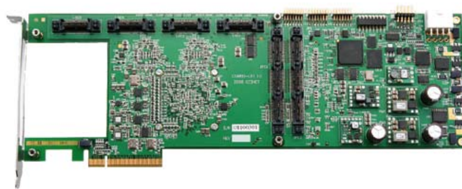
Obr. 2 – Karta rozhraní COMBO10G4TXT se čtyřmi porty 10GE
